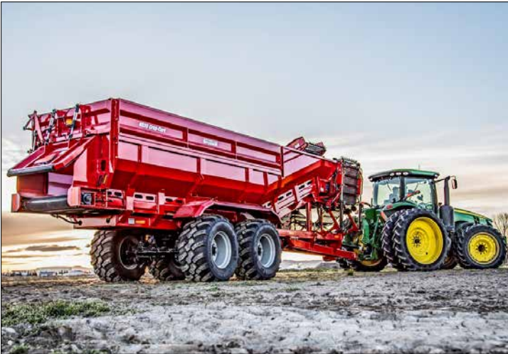
Grimme Crop Cart. Grimme Crop Cart 4820 lastar 20 ton och har boggie. Höger och vänster sida kan fällas ner hydrauliskt.
