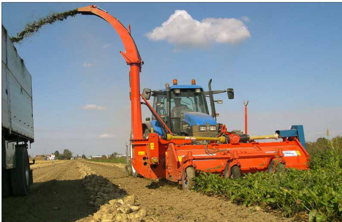
Frontblastare. Maskinen på bilden kastar blasten åt höger (så kör man i Italien). Den maskin som ska köras i Sverige kommer att kasta blasten åt vänster.
