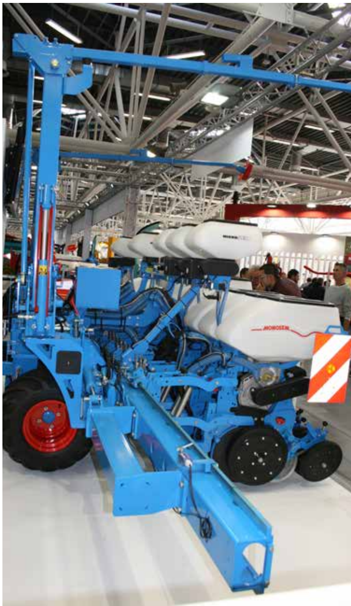
Ny precisionssåmaskin från Monozem. Nya Monozem Multislide kan med hydraulik förflytta såaggregaten med 2,5 centimeters intervall från 45 till 80 centimeters radavstånd.
