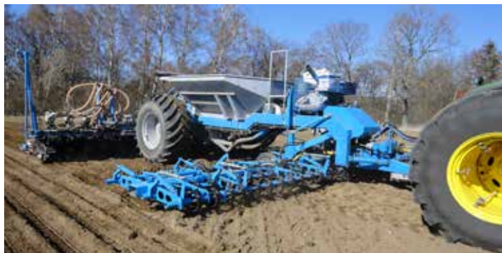
Betsädd med Advancer. Bearbetning, radmyllning av två gödselmedel samtidigt, återpackning och precisionssädd med skivbillor i en överfart.
