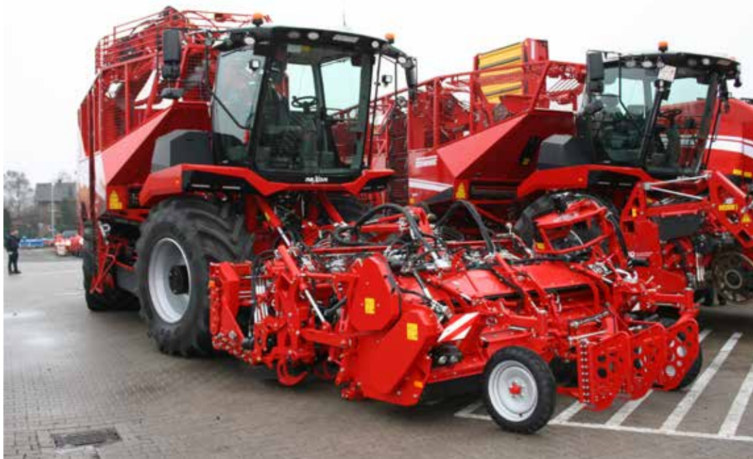
Spetsig tank ger ökad sikt bakåt. Nya Rexor 6200 och 6300 Platinum har en tank som är spetsig framåt, vilket ger ökad sikt bakåt.
