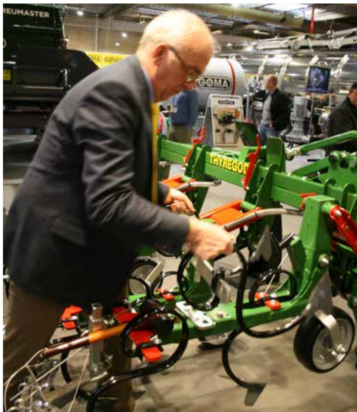
Med hammare. Med endast en hammare justeras samtliga redskap på Thyregods radrensare TRV.
