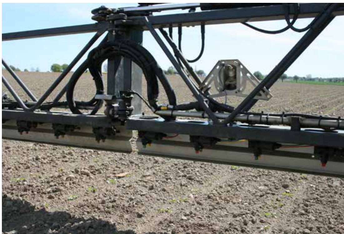
Perfekt följsamhet. Med fyra sensorer som sänder uppgifter till en dator som i sin tur justerar rampen 20 gånger per sekund blir följsamheten över grödan perfekt.
