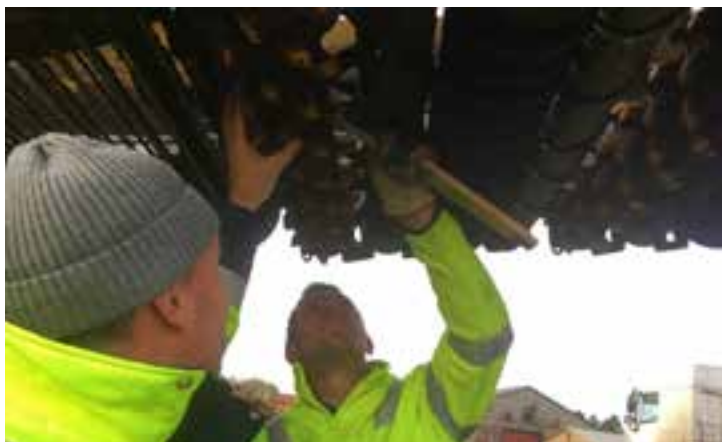
Valsar och rullar. Rensaggregatet med reverserande valsar och rensrullar kontrolleras tillsammans med entreprenören.
