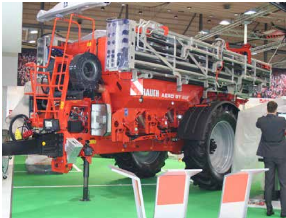
Rauch Aero GT. Nya Rauch Aero GT lastar 6 300 liter och har en ramp på upp till 36 meter med 1,2 meters sektionsskontroll.
