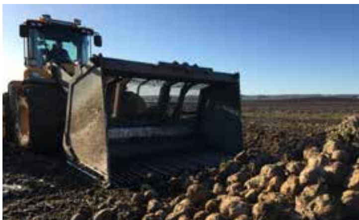
Lastmaskinen viktig. När rensverk används är lastmaskinens kondition också en viktig del i översynen, som bl.a läckage, däckutrustning och en betgrep med hela och raka horn.
