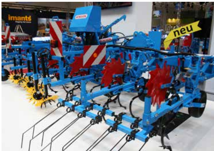
Fransk radrensare. Radrensare från Monosem med flera olika alternativ vad gäller efterredskap.
