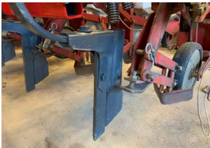
Bill från Finland. Såbillen till den ombyggda maskinen är av fabrikatet Tume.
