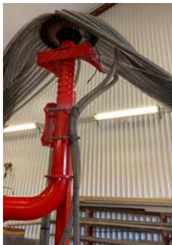
Ny fördelare. För att kunna mata varje bill med två rör valdes denna nya fördelare från Väderstad.
