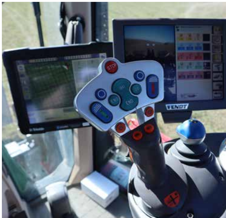
Övervakning med ISOBUS-standard. Elektronikn följer ISOBUS-standard och därmed kan maskinens alla funktioner övervakas och manövreras via traktorns originalreglage och terminaler.
