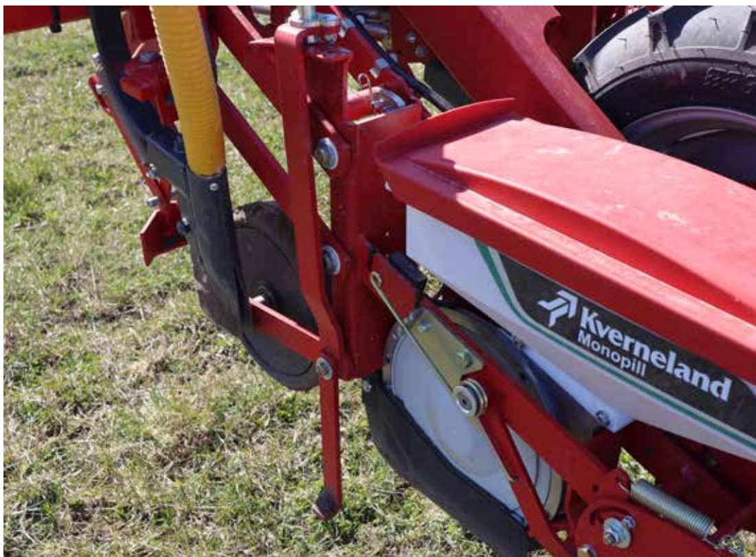
Gödselbilen monterad i S-pinne. Gödselbilen är monterad i en S-pinne och sitter på betsåmaskinens originalram.
