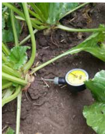
Penetrometermätning i fält. Studierna visar att den handhållna penetrometern ger samma resultat som labbstudierna.
