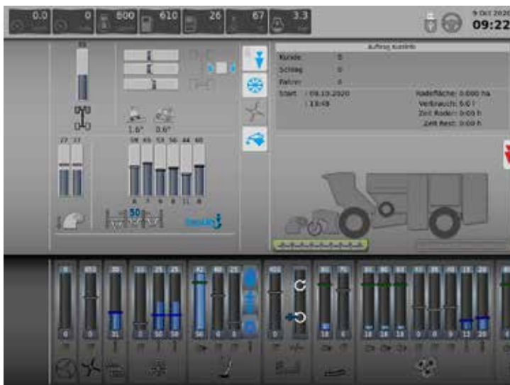
Inställningar. I monitorn ställer föraren in hur hårt blastaren ska gå och hur djupt oppelhjulen ska arbeta. Sen sköter automatiken resten.
