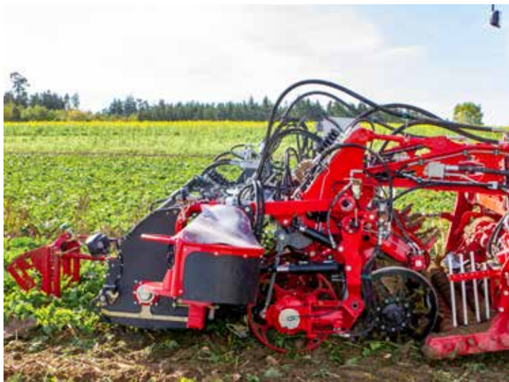
Oppelhjul. De hydrauldrivna oppelhjulen rullar i exakt samma fart som betupptagarens framkörningshastighet och lyfter sockerbetan skonsamt rakt upp ur jorden.
