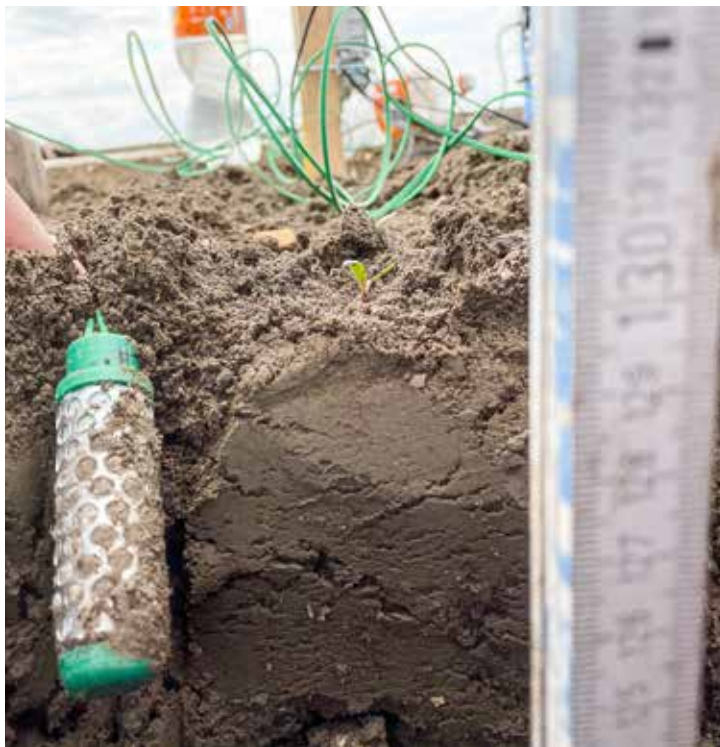
På djupet. Sensorer för att mäta vattenhalten i marken under säsong är placerade på tre olika djup från ungefär 25 till 135 cm.
