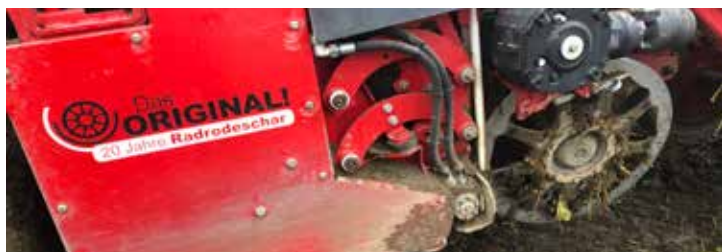
Oppel-hjul skonsamma. Hydrauliskt drivna oppel-hjul är skonsamt och får upp betorna utan rotspill.
