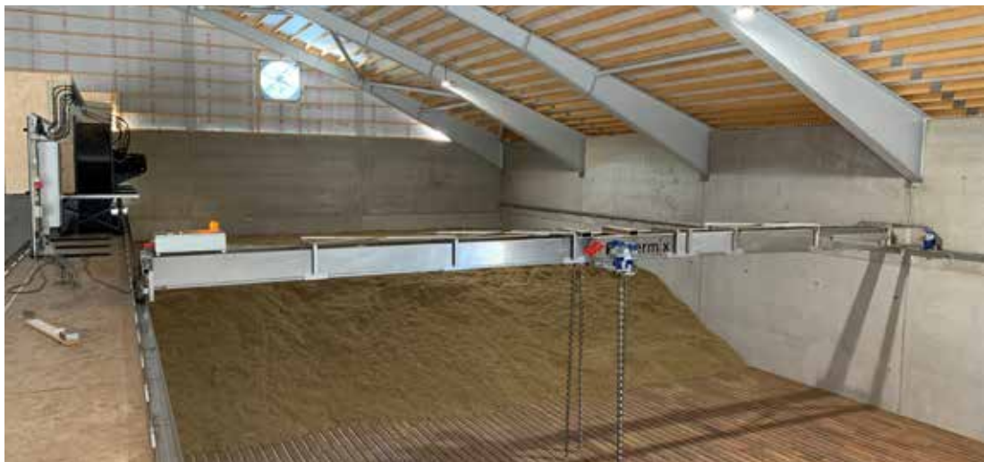
Frötorken. Den nya frötorken med Powermixer omrörare för effektivare torkning av gräsfröt.
