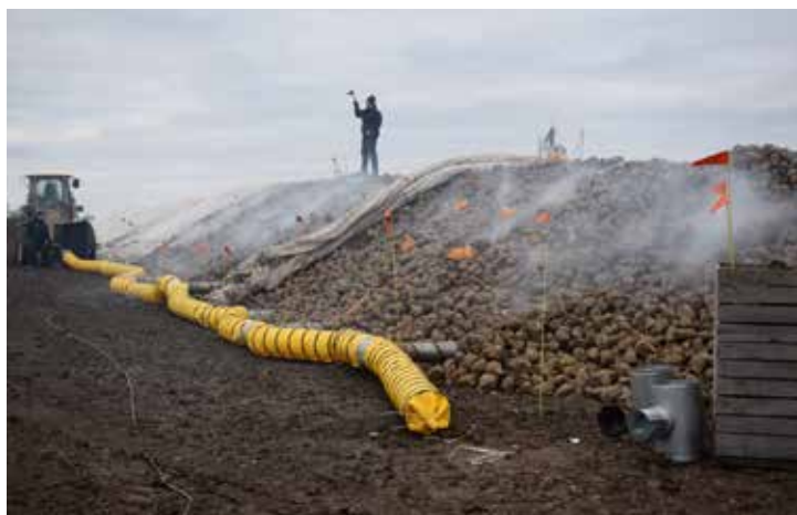
Röktest. Här studeras luftflödet med hjälp av rökpatroner som placerats vid fläkten. Testet syftade till att optimera avstånden mellan ventilationsrören.
