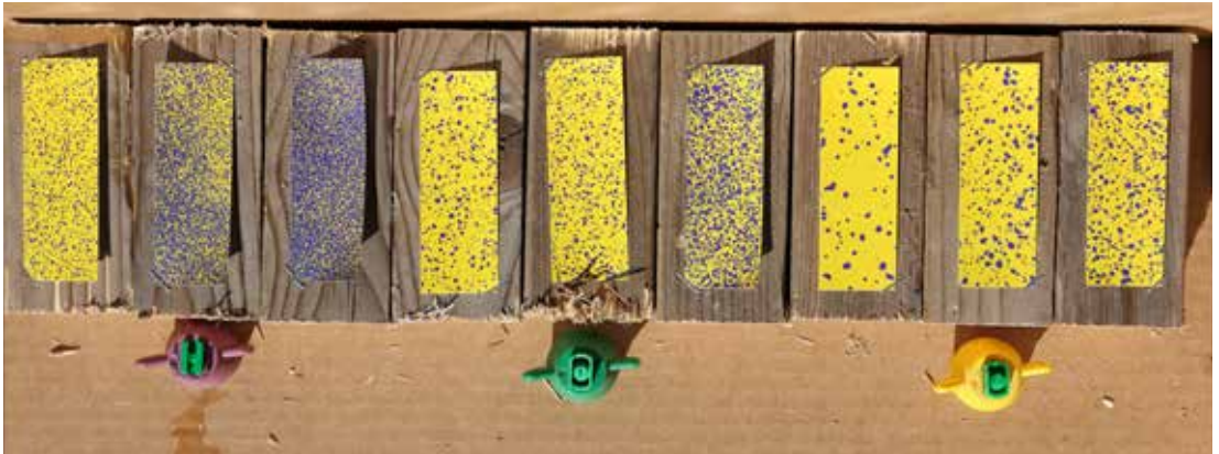
Vattenkänsligt papper. Från vänster i bild, resultatet av spaltmunstycket vid 1,5, 3 och 5 bar följt av det kompakta injektormunstycket och därefter det två-håls vinklade munstycket.
