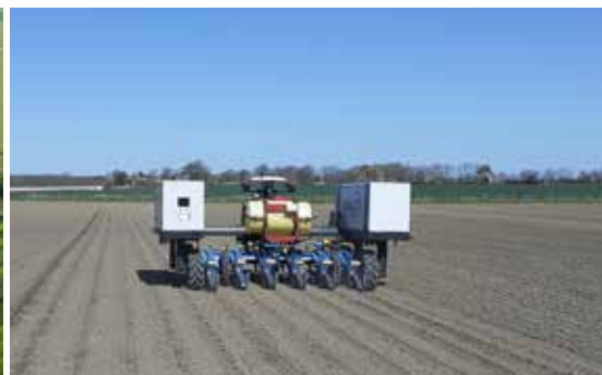
Betsådd med Robotti. Här sås sex rader betor åt gången med Agrobotic Robotti för att undersöka effekten av mer biodiversitet på fältet.
