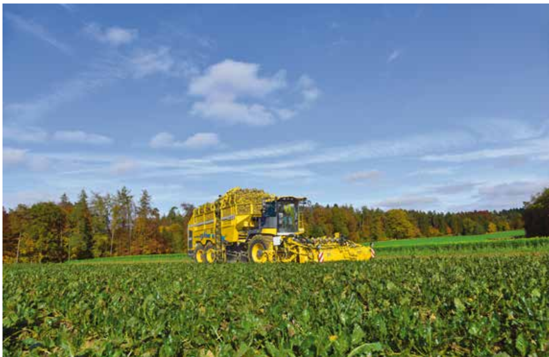
Ropan i arbete. Motorn är en Volvo med sex cylindrar och 796 hästkrafter. Den arbetar på 1 100 rpm.
