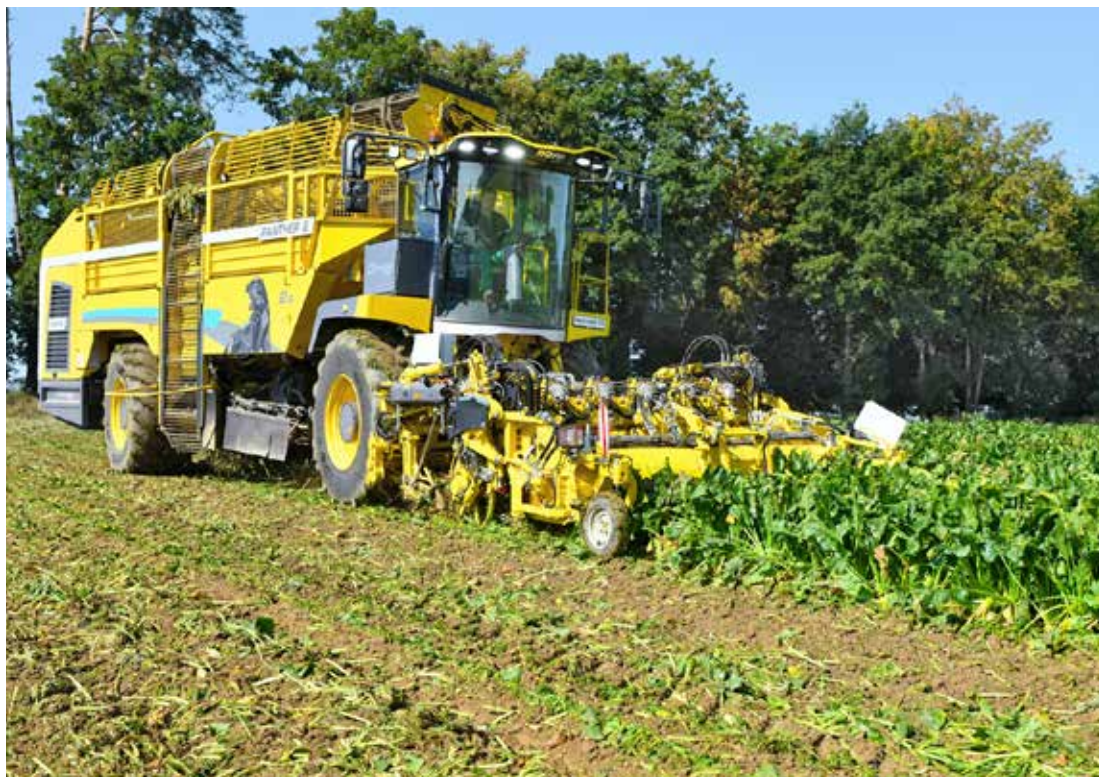
Automatisk nackning. Maskinen har automatik för nackning så att alla betor blastas och nackas exakt. Systemet anpassar även billarnas djup automatiskt efter förhållandena.
