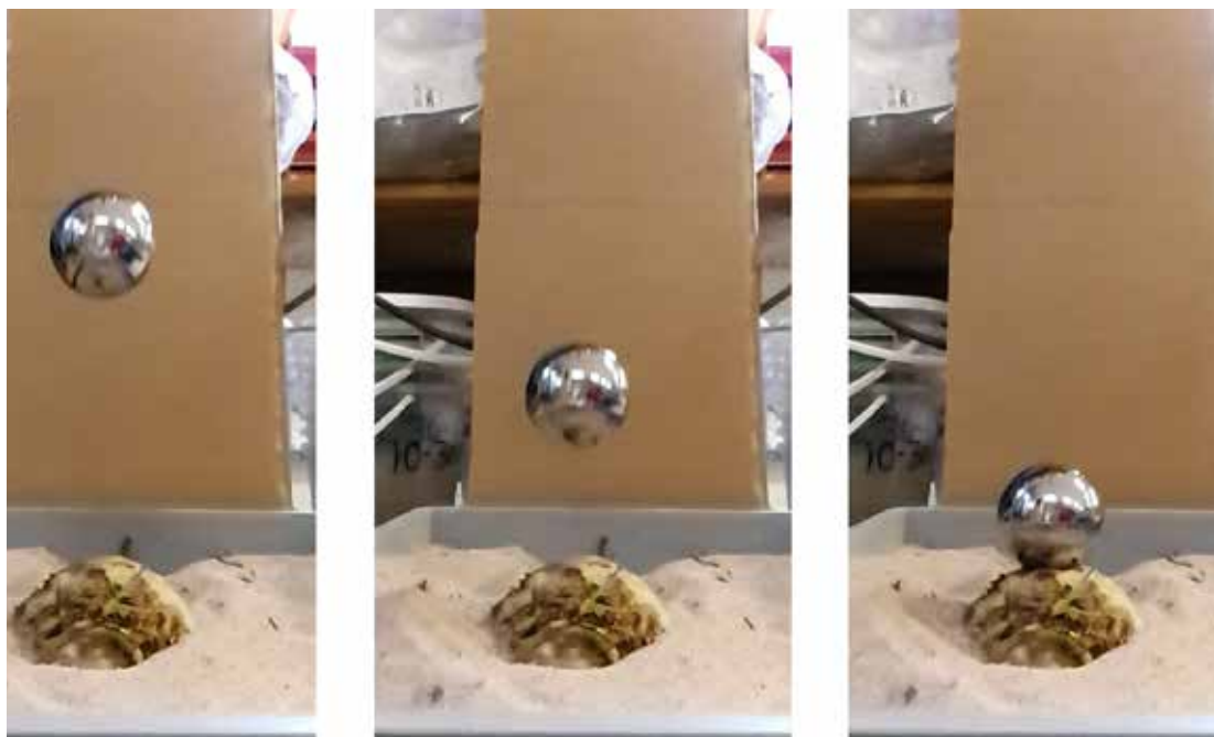
Fallande kultest. Stillbilder från höghastighetskameran. Den 1,4 kg tunga stålkulan träffar betorna med en hastighet av 4,3 meter per sekund (15 km per timme).
