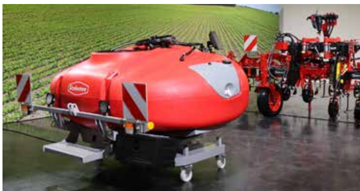
Fronttanken. Fronttanken för sprutmedel finns i 1100 och 1500 liters version och pumpen drivs av hydraulik.
