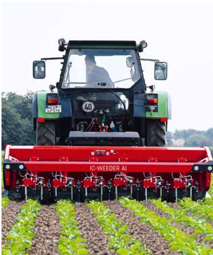
Olika arbetsbredder. IC-Weeder AI finns i olika arbetsbredder. Här en tre meter bred maskin som rensar ogräs mekaniskt i sex rader sockerbetsrader med 50 centimeters radavstånd.
