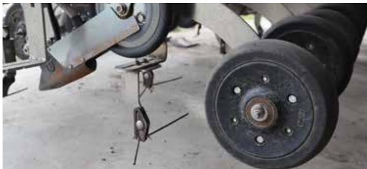
Ståltrådar i stället för knivar. Ogräset rensas med tunna ståltrådar. Dessa håller sig lättare rena än knivar vid låga hastigheter. Det passar bra då maskinen arbetar mellan 0,5 och 1 km/h.
