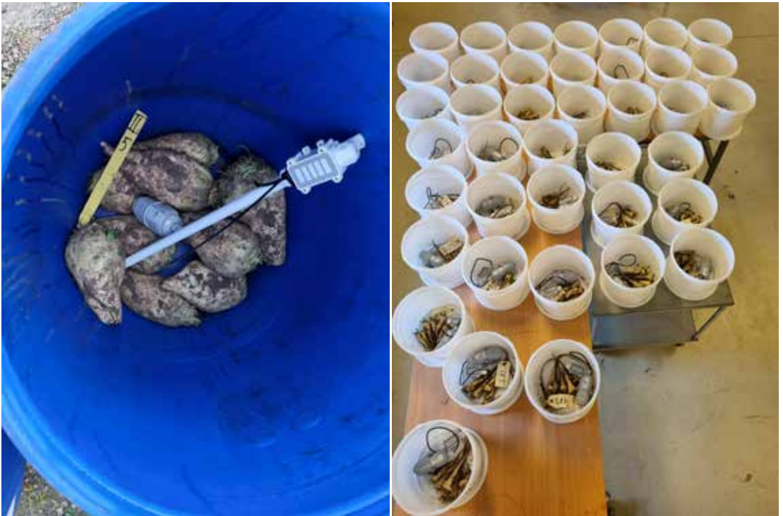
Respiration med koldioxidlogger. I tester både tidigt och sent på säsongen mäts olika sorters "andning".
