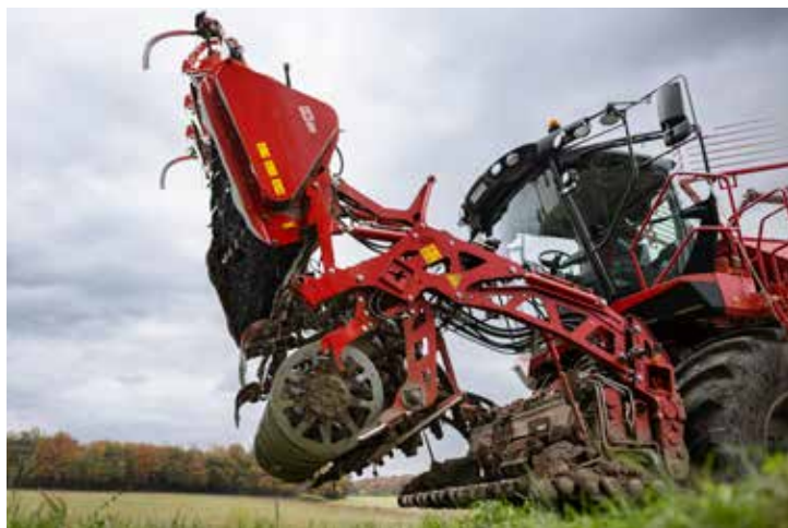
Förbättrad prestanda. Skördaraggregatet är mer genomsläppligt för ökad överblick för föraren. Konstruktionen är lättare och underhållet mindre.
