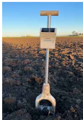
Jordanalysinstrumentet med spadlika drag. Med det digitala tyska mätinstrumentet Stenon FarmLab flyttas laboratoriet ut i fält.
