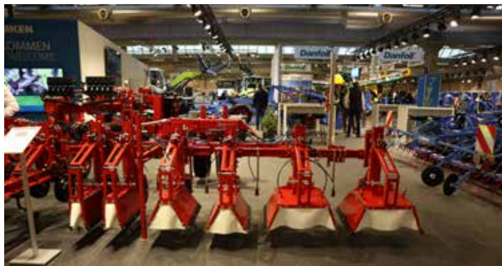
Steketes nya huvar. Med Steketes nya huvar i tre olika storlekar kan ogräspreparat sprutas i många olika grödor för bekämpning i gångarna. Ett munstycke rakt över raden kan applicera herbicid rakt över grödan.
