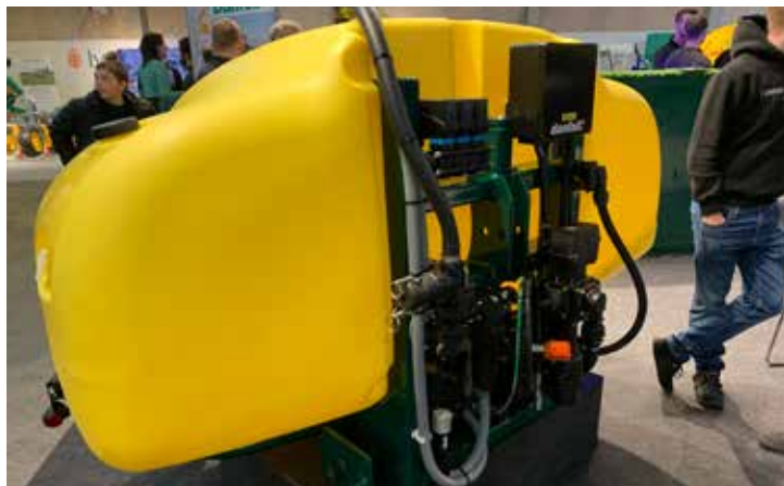
Danfoils FlexTank. Danfoils FlexTank finns i storlekarna 1 500 och 1 900 liter och är egentligen en komplett växtskyddsspruta fast utan ramp. Den monteras i traktorns frontlyft och drivs med hydraulik.
