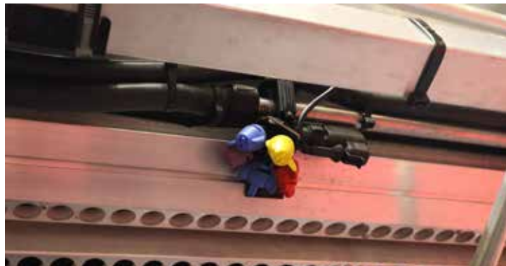
Hardis pulssystem. Hardis pulssystem där munstyckena kan öppna och stänga 20 gånger per sekund går nu i serieproduktion och finns som tillval på flera av fabrikatets växtskyddssprutor. Genom den tekniken kan dosen minskas eller ökas utan att trycket förändras. Växtskyddssprutan kan köras i variabel hastighet och exakt rätt mängd vätska kan sprutas ut med bibehållen droppstorlek.
