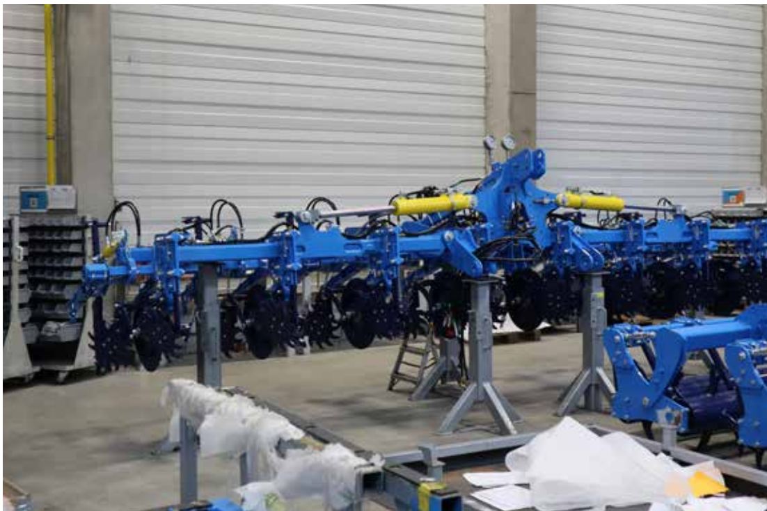
Impact precisionssåmaskin. Farmet Impact i monteringshallen utan såhus monterade. Maskinen kan köras för sig själv i en traktors trepunkt, i kombination med en fronttank på traktorn, eller bakom en Falcon såmaskin.
