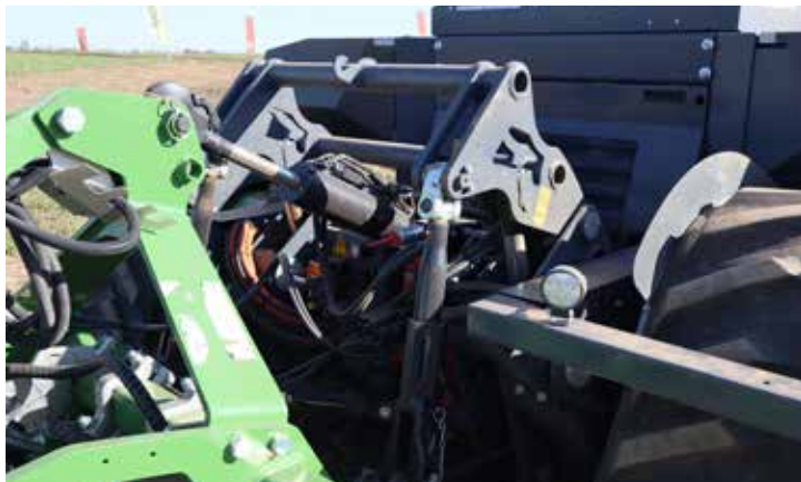
Bakre utrustning. Bak på AgBot 5.115T2 finns trepunkt, yttre hydraulik, ISOBUS-uttag samt kraftuttagstapp, precis som på en konventionell traktor.
