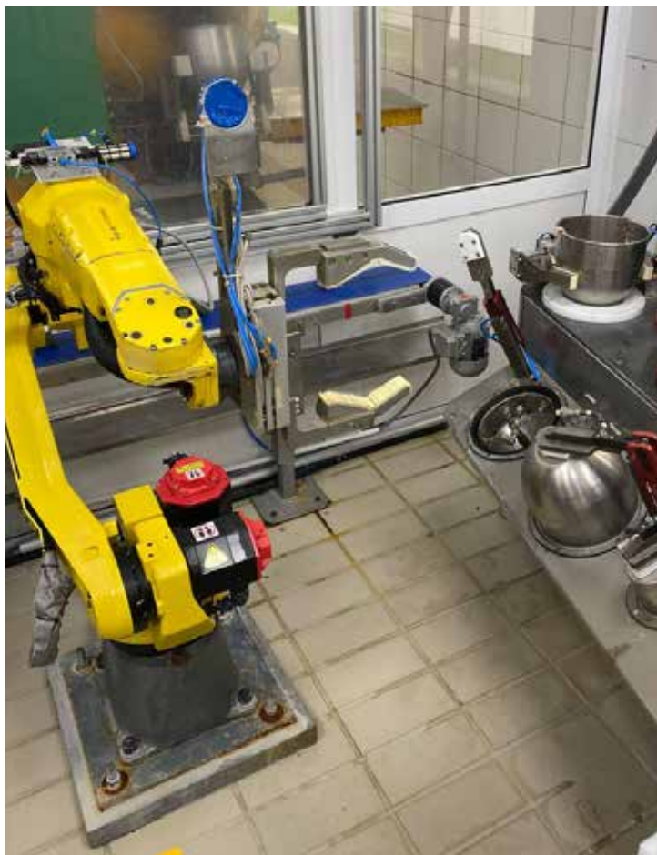
Robot som tillreder analysvätska för fastställande av sockerhalt.
