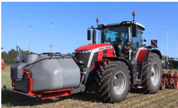
Tvådelad fronttank för två blandningar. En i raden och en i gången.
