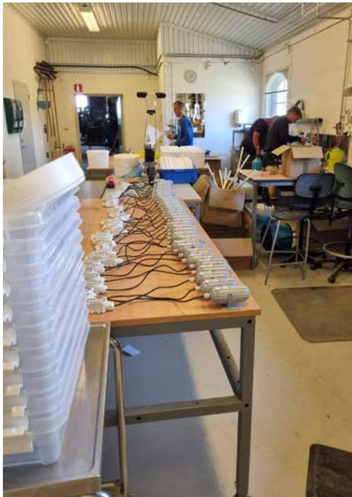
Förberedelser inför respirationsförsök. På bordet ligger 40 trådlösa koldioxidmätare som kalibrerats för att användas i försöken.
