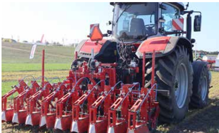
Bandsprutan från Stekete har huvur för att skydda grödan och sprutmunstycken både i huvur och till gången mellan huvarna. Radavståndet kan regleras från 45 till 75 centimeter.
