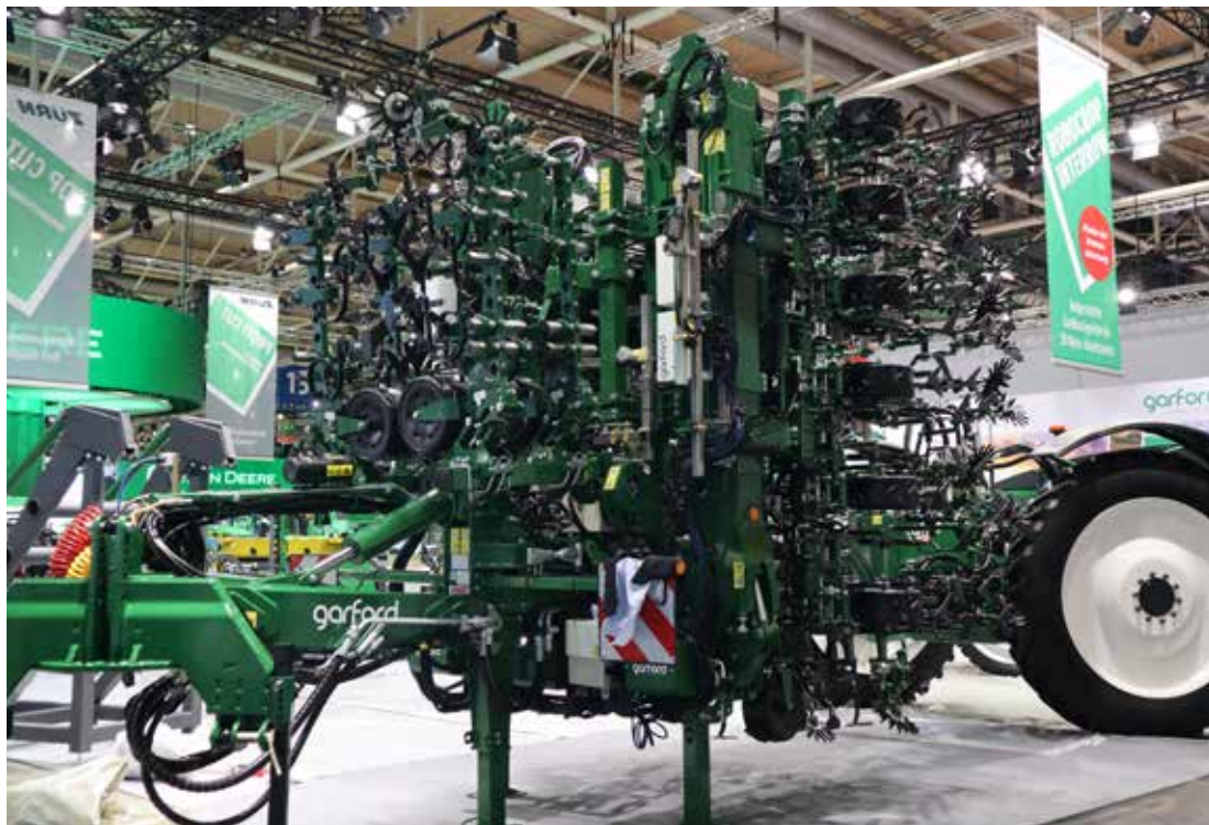
Garford Robocrop. Garford visade nya bogserade Robocrop som finns i arbetsbredd från 12 till 28 meter och som endast är tre meter bred i transport.
