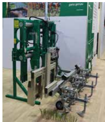
Ram från Reichhardt. Med den här ramen från tyska Reichhardt blir den gamla stela radhackan modern. Med kamerastyrning och sensorer går aggregaten rätt i raderna.
