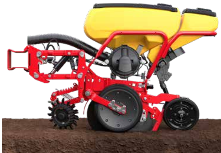
Tempo Rowunit. Sensorer övervakar förhållandet i fält och anpassar billtrycket så såddjupet hela tiden är exakt.
