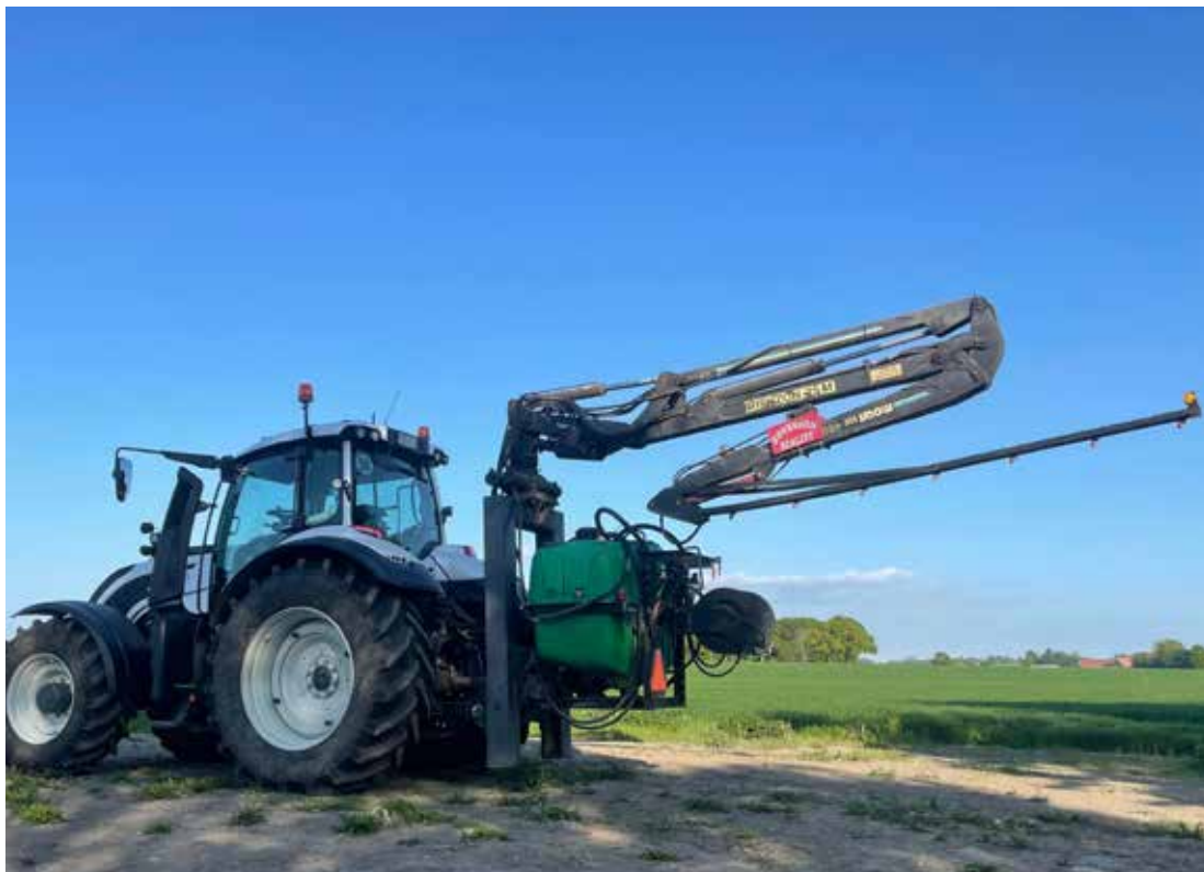
Framtidens frostskydd? En skogskran med en gammal bomspruta monterad är NBR:s senaste investering.
