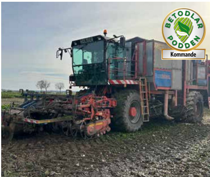
Försöksbetupptagare från tillverkaren Holmer. Upptagaren, som tar tre rader åt gången, är från 1997 och har byggts om så att den i stället för en bettank har ett inbyggt analyslaboratorium.
