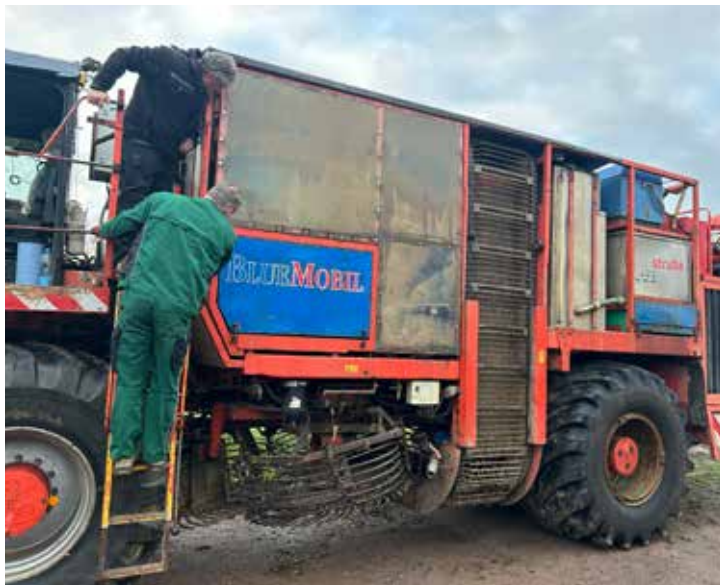
Skördemaskinen är helt rekonstruerad. På bilden syns rouletter där betorna kommer in i analyslaboratoriet. Bakpå finns en vattentank med vatten som används till bettvätt, och det finns även en stor generator som förser hela anläggningen med ström.
