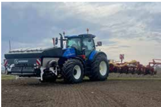
Traditionell sårmaskin. Vår sårmaskin är en traditionell monopill där vi har byggt på myllningsaggregat till gödningen.
