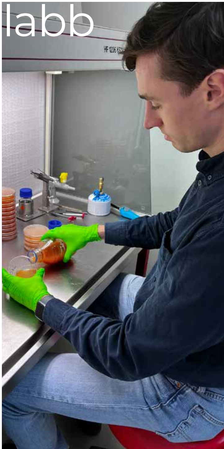
Plattgjutning. Här gjuter jag agarplattor till plattmetoden i NBRs labb. När agarlösningen är varm är den flytande och kan hällas i skålarna. När lösningen svalnar stelnar den och svampen kan sedan växa ovanpå agarn.
