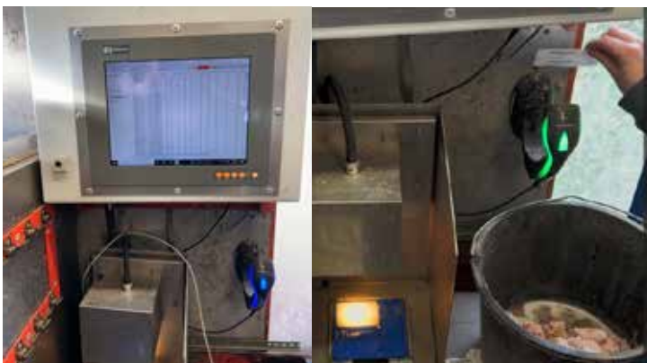
Analys av sockerhalt. Med nära infraröd spektroskopi och inbyggd dator kan betornas sockerhalt analyseras effektivt och precist.
