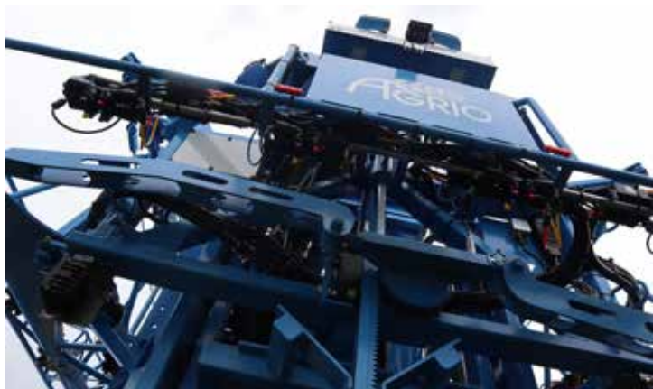
Agrio självgående spruta. Agrio Dino 3 är tredje generationens självgående spruta. Dino 3 har ny drivlina, upp till 36 meters arbetsbredd och avancerade lösningar för precisionssprutning.
