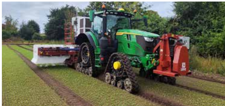
Carbon Robotics LaserWeeder. Ogräsen skjuts ihjäl med en laserstråle. Bilden är tagen i en spenatodling utanför Landskrona. Bilden på föregående sida visar resultatet.
