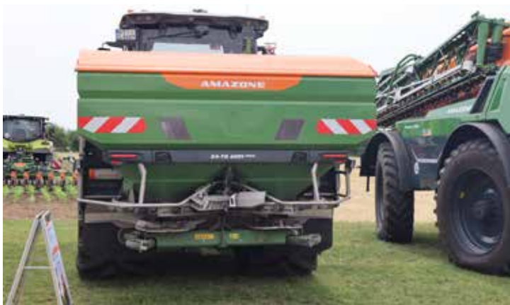
Amazon AutoSpread-system. Amazones silvermedaljbelönade AutoSpread-system mäter den verkliga spridningsbilden under körning och justerar automatiskt spridarens inställningar med hjälp av AI.
