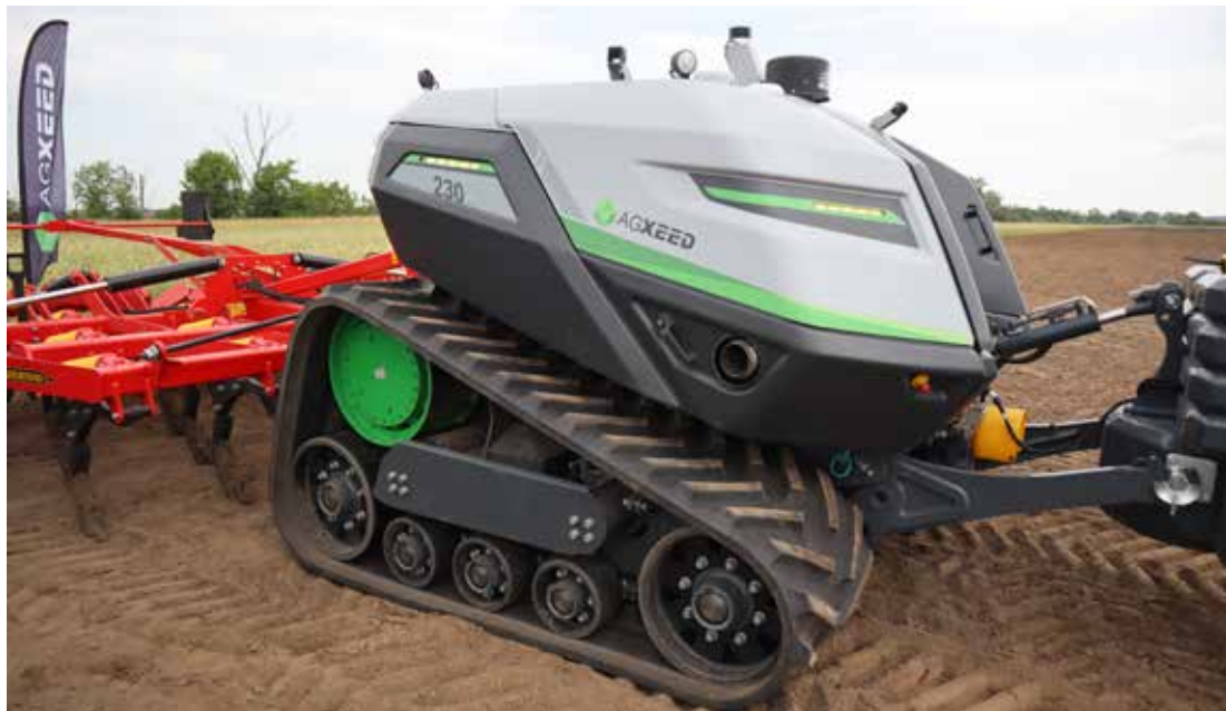
AgXeed 7-serien. Den nya AgXeed 7-serien utvecklar 230 hästkrafter och är konstruerad från grunden för autonom drift utan hytt.
