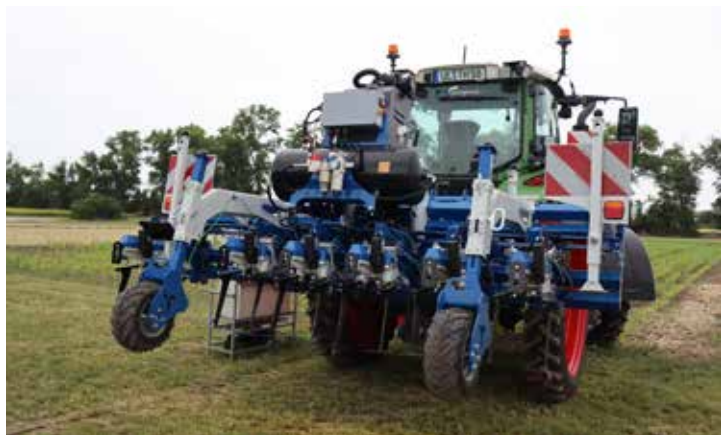
Zasso radhacka. Den österrikiska tillverkarens Zassos radhacka använder kameror och elektronisk djupkontroll för stor precision i grönsaks- och specialgrödeodlingar.
