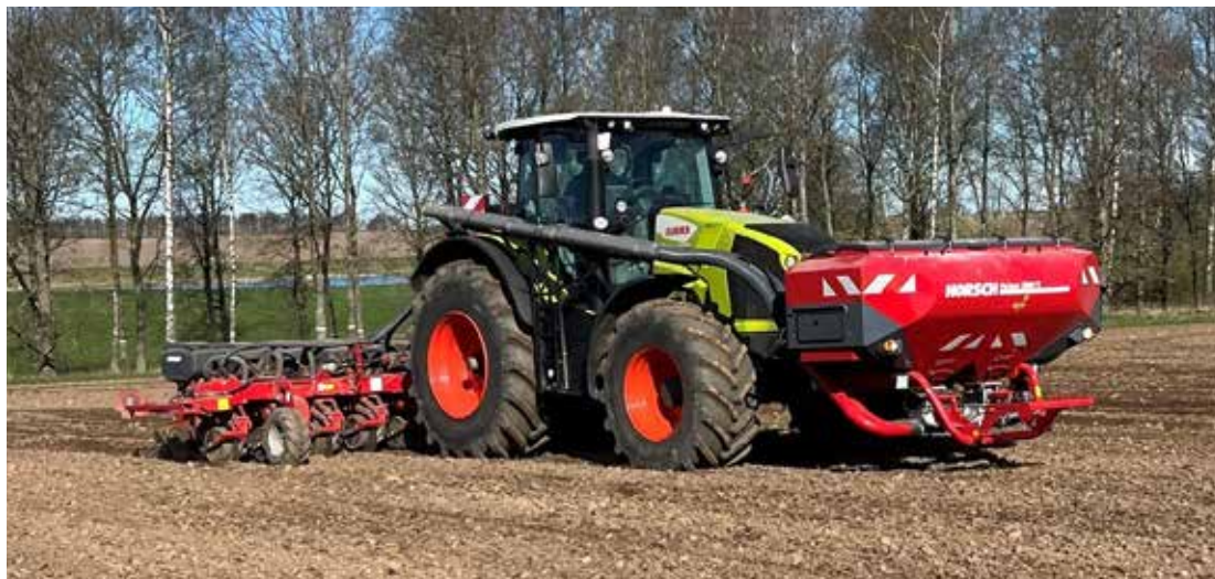
Vi sår med en Horsch Maestro och kombisår två gödelsorter enligt markkarteringens styrfil för att anpassa näringen efter fältens variation.
