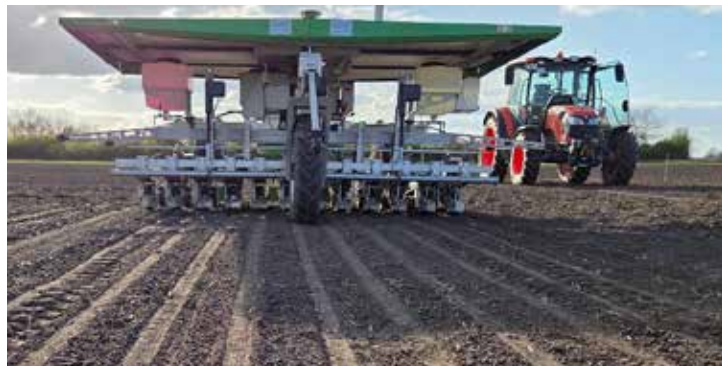
FarmDroid FD20 är den maskin som tydligast gått från pionjärfas till kommersiell användning i sockerbeter. Den kan börja rensa redan innan grödan syns.
